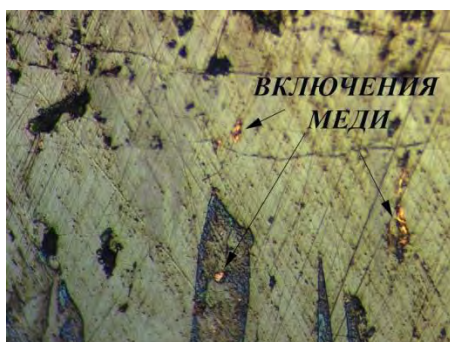
Рисунок 2 – Микроструктуры термодиффузионного однофазного боридного слоя с включениями меди, \times 1000
