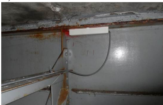
Рис.2. Интеллектуальные датчики механических напряжений, установленные на верхнем поясе и на опорных элементах моста и закрыты защитным кожухом.
