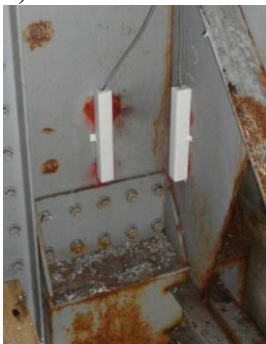
Рис.2. Интеллектуальные датчики механических напряжений, установленные на верхнем поясе и на опорных элементах моста и закрыты защитным кожухом.
