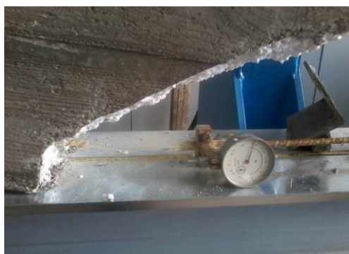
Рис. 6. Место разрыва арматуры
