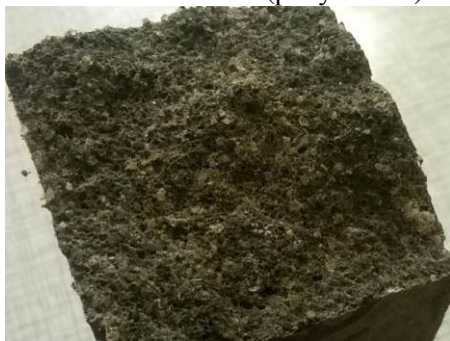
Рис. 10. Поверхность разрушения образца из ПЦ молотого совместно с волокнами ИКТ
