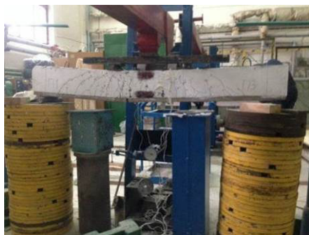
Рис. 2. Вид балок после разрушения
