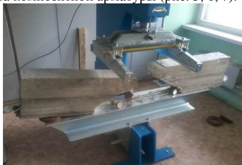
Рис. 5. Опытный образец после разрушения в результате разрыва арматуры
