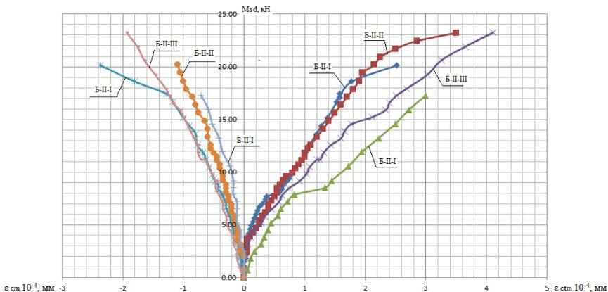
Рис. 4. График «момент – относительные деформации в бетоне»
