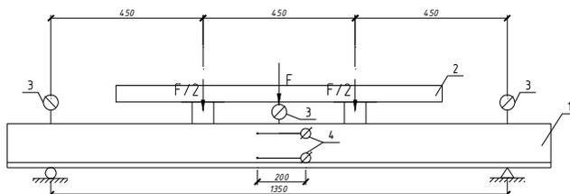
1 – опытная балка; 2 – траверса; 3 – прогибомер; 4 – индикаторы часового типа
