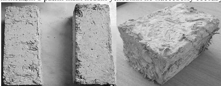
Рис. 2. Образцы из геополимерного конструкционно-теплоизоляционного фибробетона с органическими фибровыми наполнителями растительного происхождения, изготовленные в формах (слева) и выпиленный из массива (справа)
