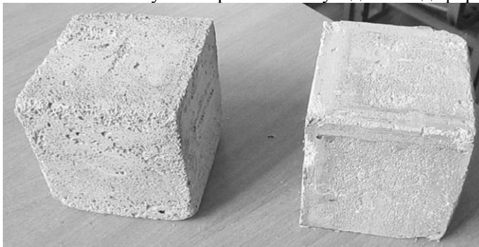
Рис. 3. Образцы из неавтоклавного газопенобетона на смешанном вяжущем с органическими фибровыми наполнителями растительного происхождения различных составов
