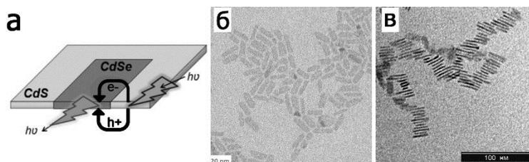
Рисунок 1 – Диаграмма, демонстрирующая принцип действия «фотонной антенны», (а) и ПЭМ-снимки отдельных КНП CdSe (б) и их агрегатов (в).
