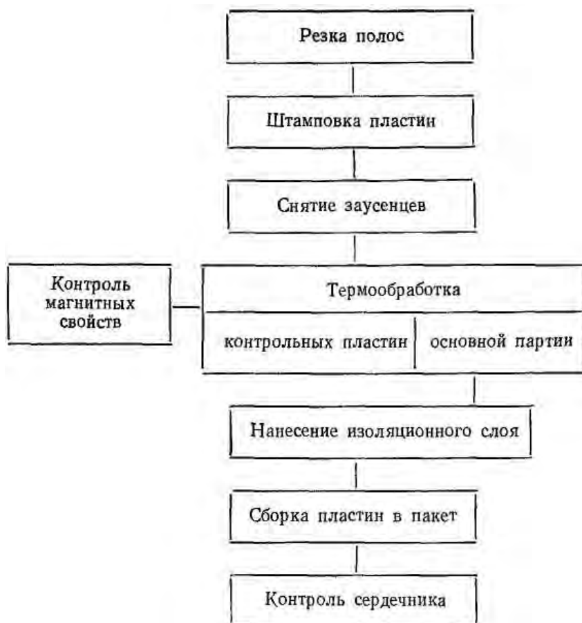
Рисунок 6.3 – Технологическая схема изготовления пластинчатых магнитопроводов
