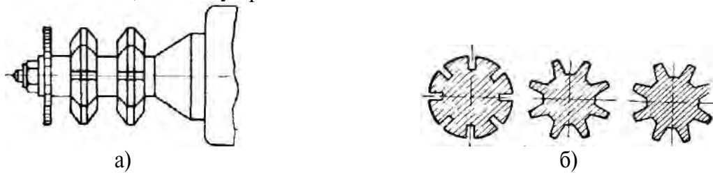
Рисунок 1.48 – Схема фрезерования зуба в три перехода: а – установка фрез, б – последовательность переходов
