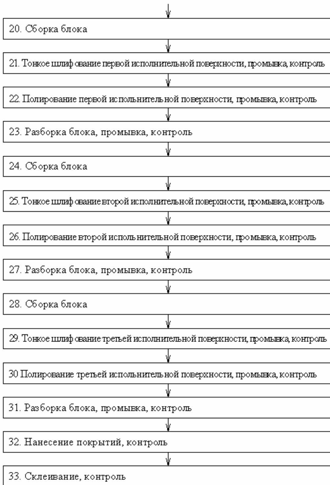
Рисунок 4.23 – Обобщенная схема технологического процесса окончательной и дополнительной обработки исполнительных поверхностей заготовок призм
