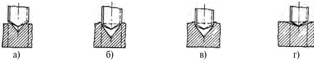
Рисунок 1.85 – Форма лунок и сверл
