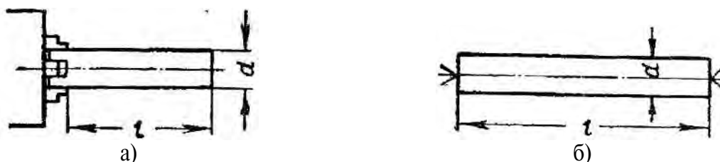
Рисунок 1.2 – Схема установки валика в патроне и в центрах: а – обточка в патроне; б – обточка в центрах
