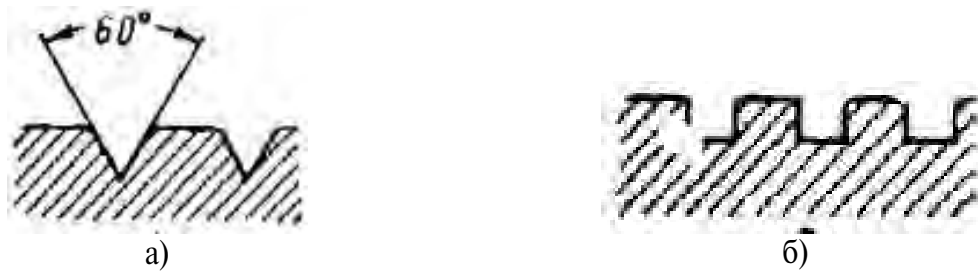
Рисунок 1.76 – Профили штрихов: а – треугольный; б – прямоугольный
