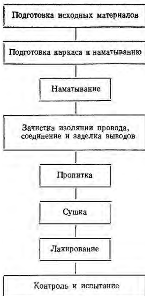
Рисунок 6.11 – Типовая технологическая схема изготовления катушек
