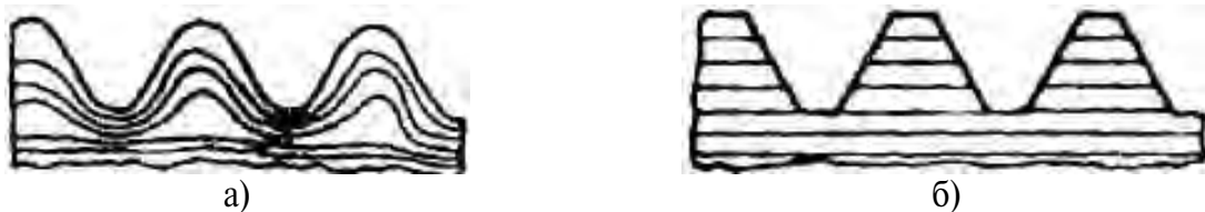
Рисунок 1.45 – Расположение волокон материала: а – накатанной резьбы; б – нарезанной плашкой резьбы
