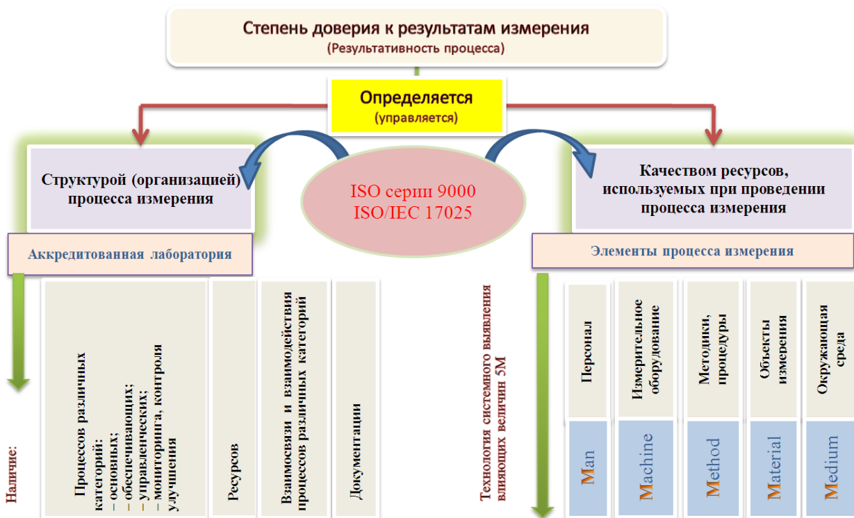
Рисунок – Концепция управления результативностью процесса измерения с позиций стандартов ISO серии 9000
