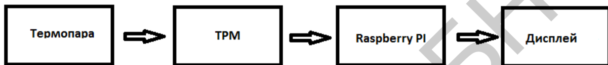
Рис. 2 – Схема измерения термопрофилей пайки
