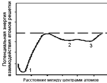
Рисунок 2. – Зависимость потенциальной энергии взаимодействия атомов от расстояний между центрами атомов.
