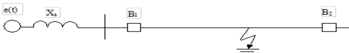
Рисунок 1 – Схема ЛЭП, оснащенной АПВ
