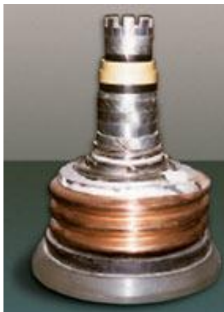
Рисунок 4 – HTСП-кабель на 3 ГВА (разработка ВНИИКП)
