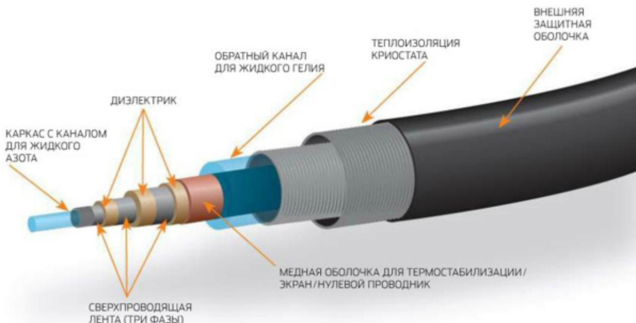
Рисунок 2 – Пример ВТСП проводника
