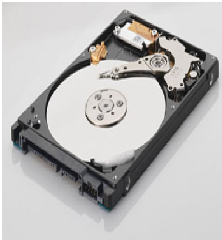
Рисунок 5 – Бесконтактный двигатель для привода жестких дисков
