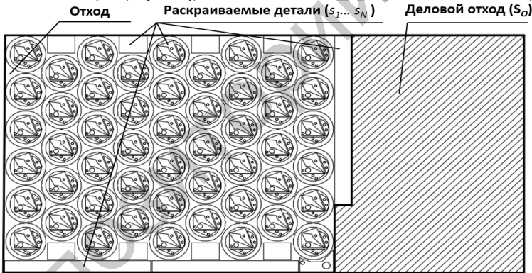
Рисунок 6. – Схема для расчета норм расхода материала при раскросе на гильотинных ножницах, машинах термической резки и установках гидроабразивной резки
