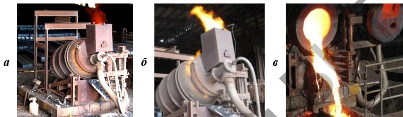
а – стадия ТФВ; б – стадия ЖФВ; в – слив металла и шлака в изложницу
