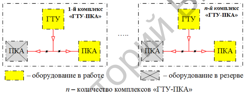
Рисунок 4. – Принципиальная схема комплекса «ГТУ-ПКА»
