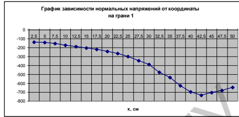
Рисунок 2. – Зависимость эквивалентных напряжений на грани 1 от координаты
