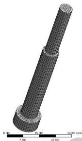
Рисунок 4. – Конечно- элементная модель пуансона
