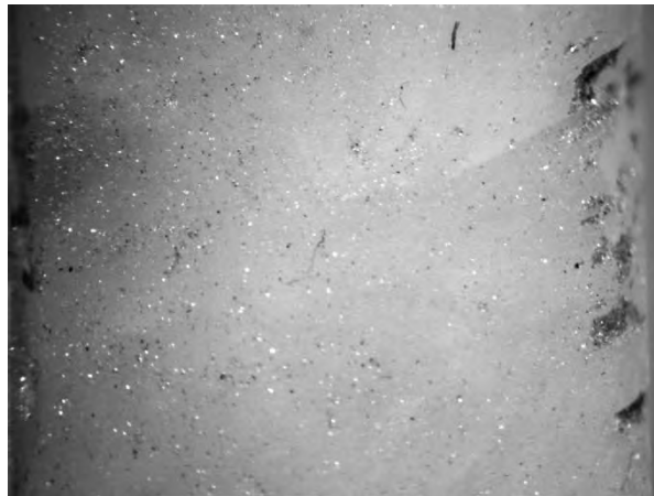
Рис. 6. Распиленная поверхность мраморного образца ( 20\times ) штрипсой в исходном состоянии рабочей поверхности (а) и после ее электроэрозионного модифицирования ( U = 75 В) (б)
