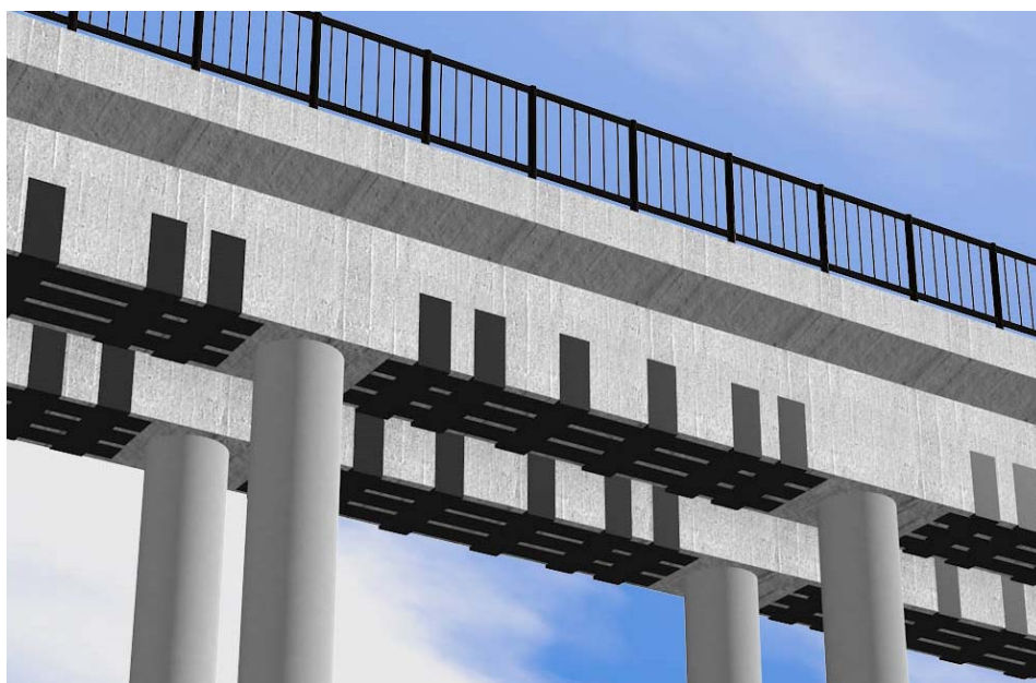
Рисунок 2 – Усиление моста углепластиком
