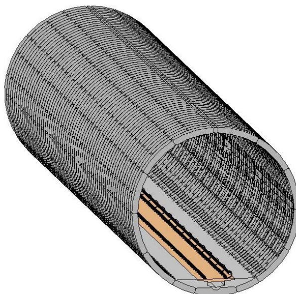
Рисунок 5 – Участок тоннеля, выполненный в Revit
