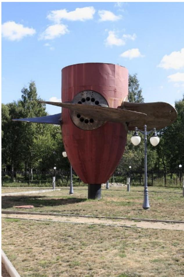
Рисунок 4 – Поворотнлопастная ГЭС
