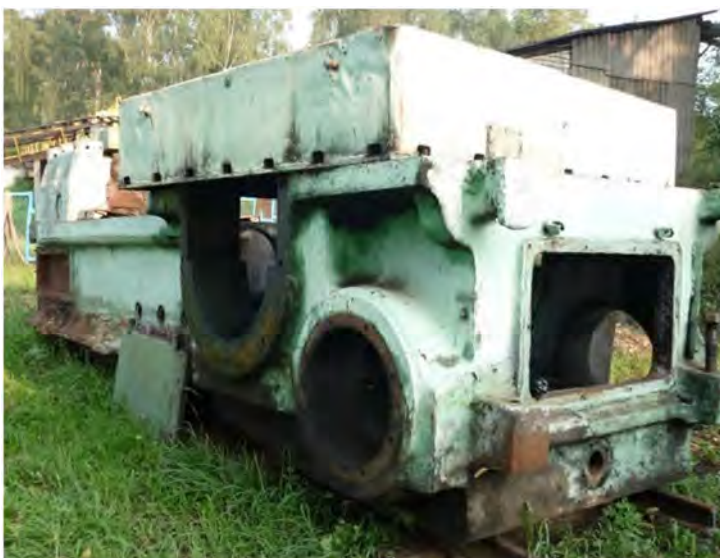
Рис.1. Общий вид цельнолитой станины двухштемпельного пресса Б8232, демонтированной для капитального ремонта
