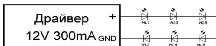
Рисунок 1 – Последовательное соединение светодиодов
