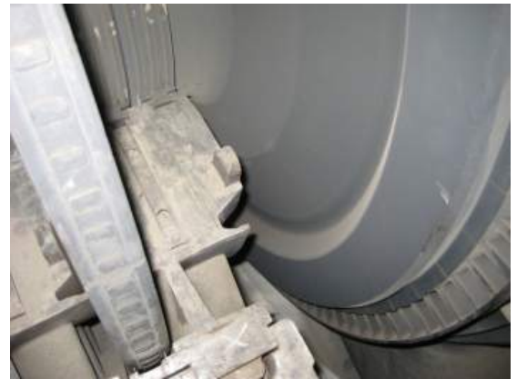
Рисунок 1 – Камера регулирующей ступени турбины К-210-130
