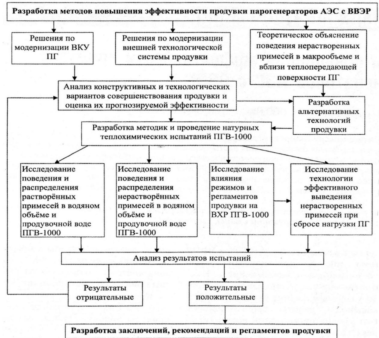
Рисунок 1 – Общая методологическая схема повышения эффективности продувки парогенераторов АЭС в ВВЭР
