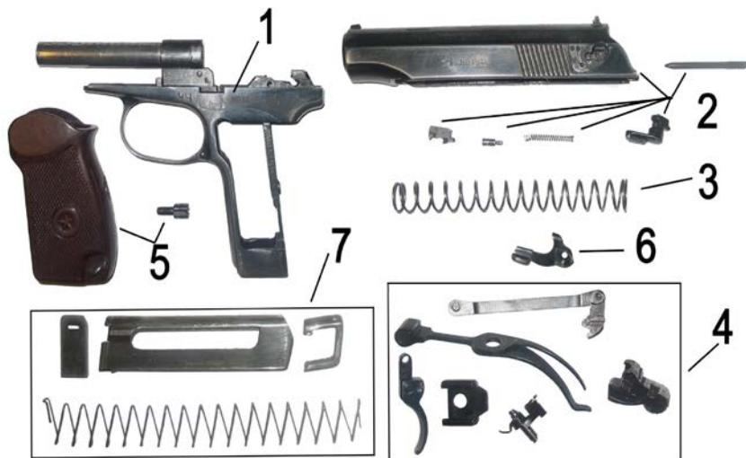
Рис. 2.3. Основные части и механизмы пистолета
