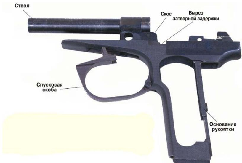
Рис. 2.4. Рамка со стволом и спусковой скобой
