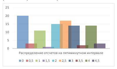
Лишь треть отсчетов, не кратных делению шкалы, кратны полуминуте. Расчет показывает, что при выполнении 2 полуприемов погрешность 0.7', при 4-0.5' и при 6-0.4'. Т.о. для достижения тридцатисекундной погрешности необходимо выполнить не менее двух приемов, как и записано в паспорте прибора. В то же время установившаяся практика измерения углов теодолитами технической точности подталкивает исполнителей к выполнению двух полуприемов, что не позволяет получить результат нужной точности.
