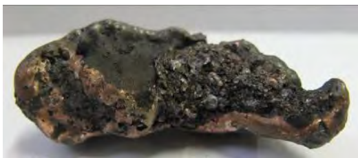
Рисунок 4.10. – Слиток омеднённого чугуна с вкраплениями корольков
