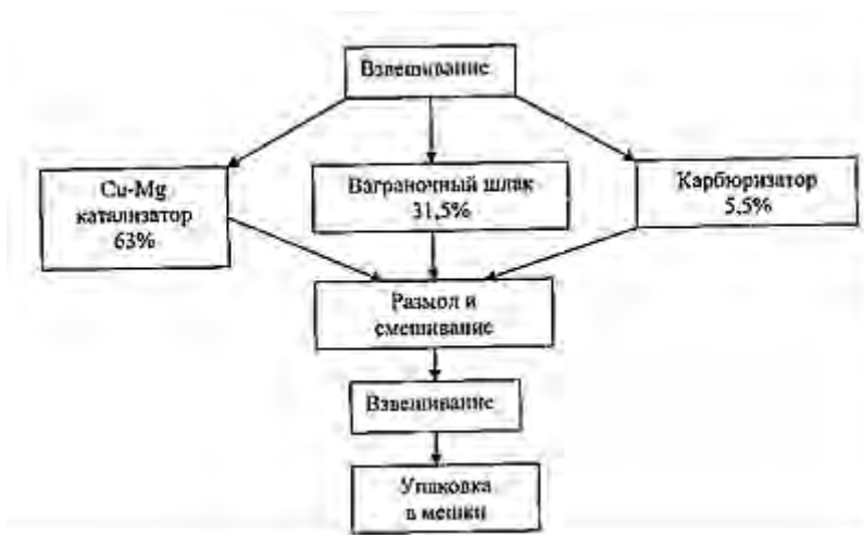
Рисунок 4.1. – Технология переработки Cu-Mg катализатора
