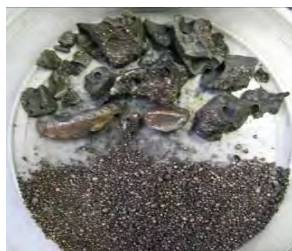
Рисунок 4.6. – Порошок отделённый магнитной сепарацией
