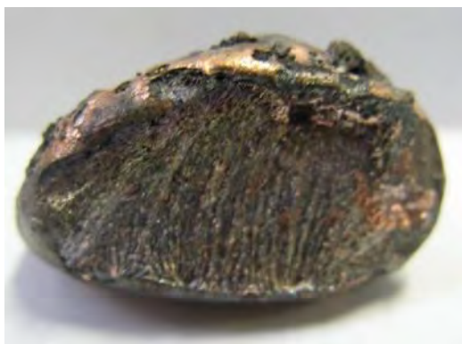
Рисунок 4.11. – Слиток чугуна легированного медью
