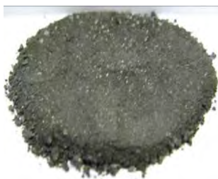
Рисунок 4.6. – Порошок отделённый магнитной сепарацией
