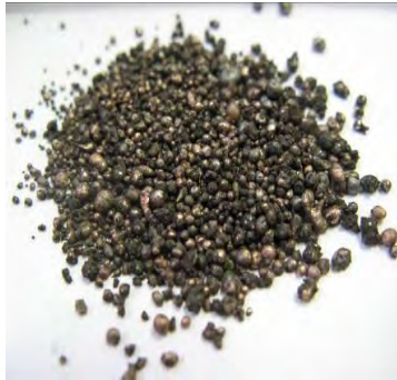
Рисунок 4.8. – Омеднённые корольки чугуна
