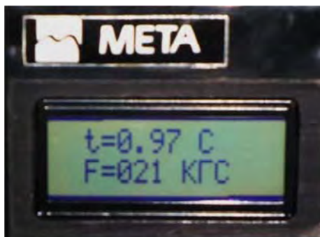
Рис. 3.8. Показатели t и F , полученные во время измерений (время срабатывания тормозной системы и усилие нажатия на тормозную педаль соответственно)
