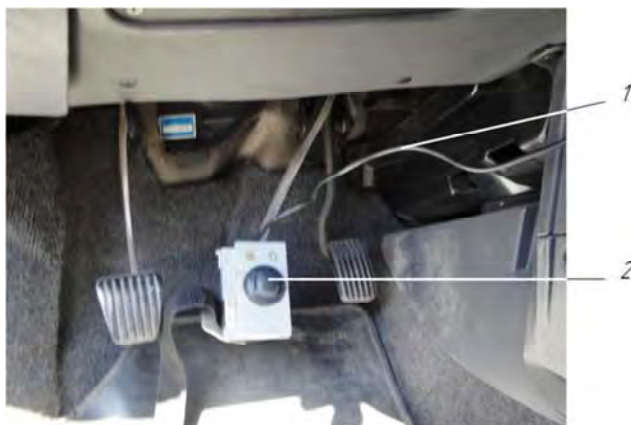
Рис. 3.3. Датчик усилия, который закреплен на тормозной педали: 1 – провод, который подключает педометр; 2 – педометр (датчик усилия)
