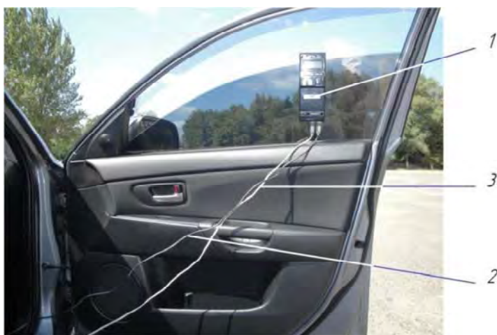
Рис. 3.2. Прибор, который закреплен на стекле с правой стороны: 1 – прибор; 2 – провод, который подключает педометр; 3 – провод питания
