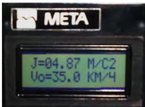
Рис. 3.7. Показатели J и V_0 , полученные во время измерений (замедление, которое установилось, и начальная скорость торможения соответственно)
