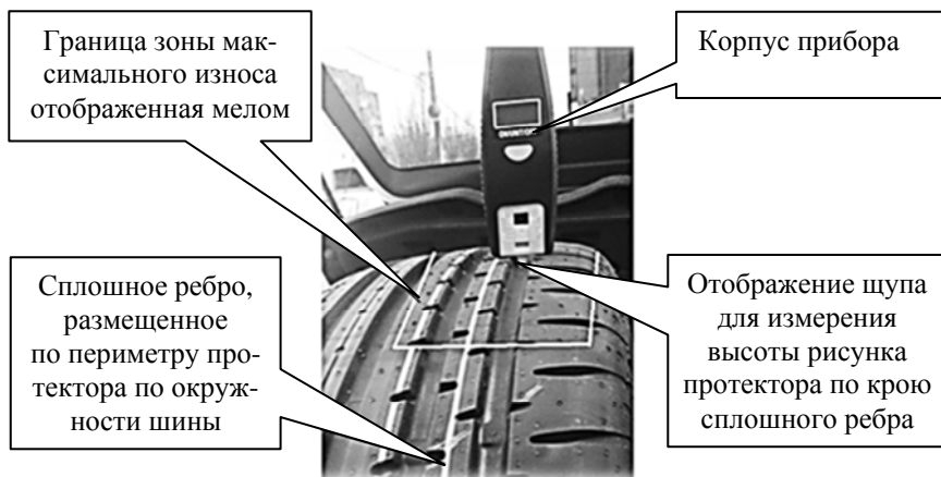
Рис. 1.2. Приспособление и его место размещения на шине во время контроля остаточной высоты по рисунку протектора
