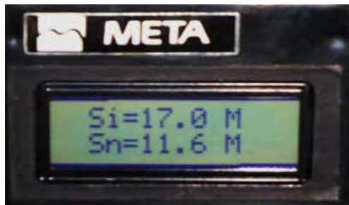
Рис. 3.6. Показатели S_i и S_n , полученные во время измерений (измеренное значение длины тормозного пути и пересчитанная норма тормозного пути соответственно)
