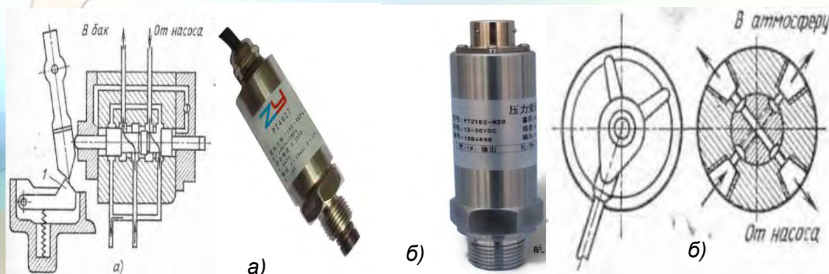
а) Схема гидравлического датчика б) Пневматический датчик
