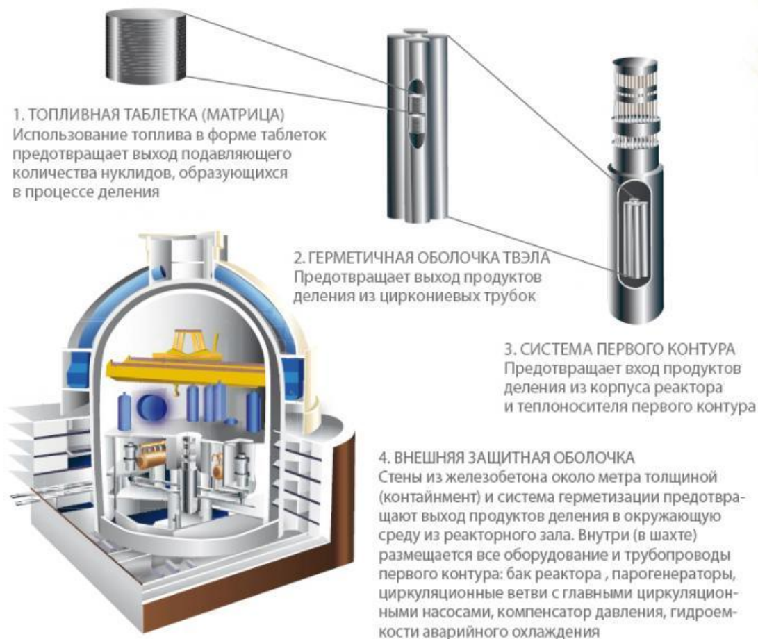
Рис.3. Защитные барьеры АЭС
