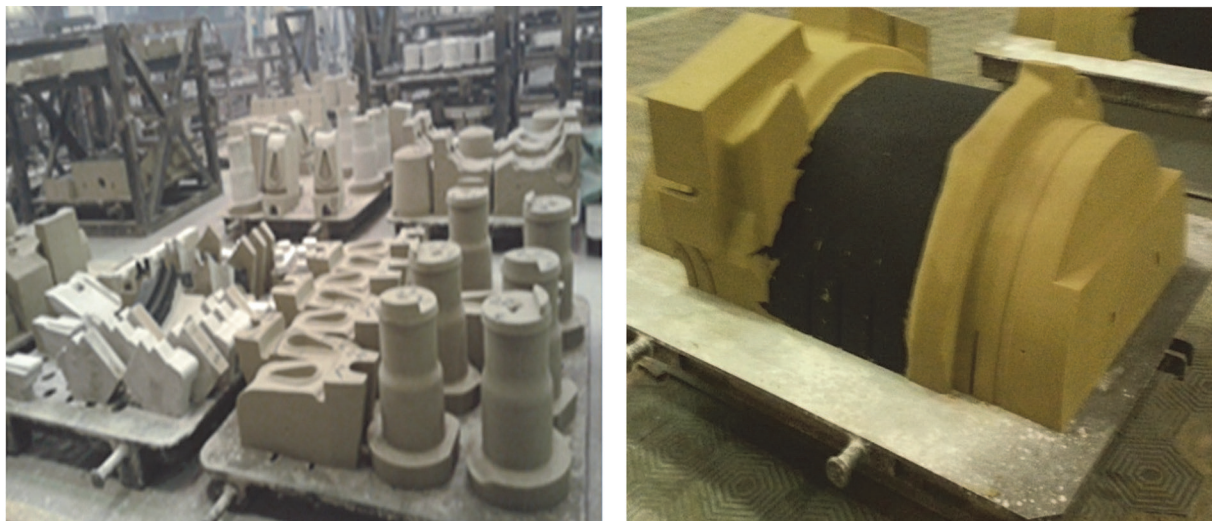
Рис. 2. Стержни для производства стальных отливок
