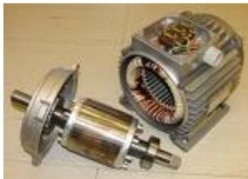
Рис. 10. Асинхронный короткозамкнутый двигатель.
