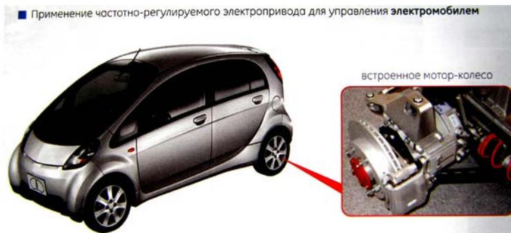
Рис. 22. Применение частотно-регулируемого привода в электромобиле
