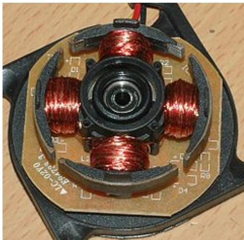
Рис. 8. Статор бесколлекторного двигателя вентилятора
