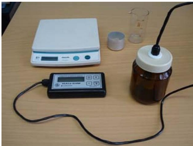
Рисунок 4.18 - Индикатор активности цемента ИАЦ-04
