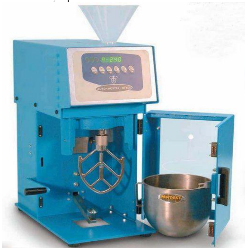
Рисунок 4.14 - Мешалка для цементного раствора
