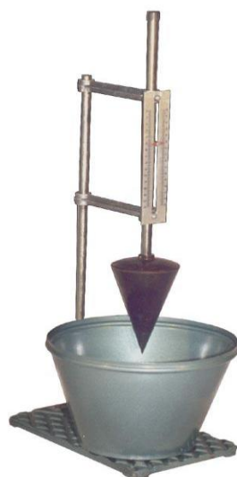
Рисунок 4.24 - Прибор для определения подвижности растворной смеси
