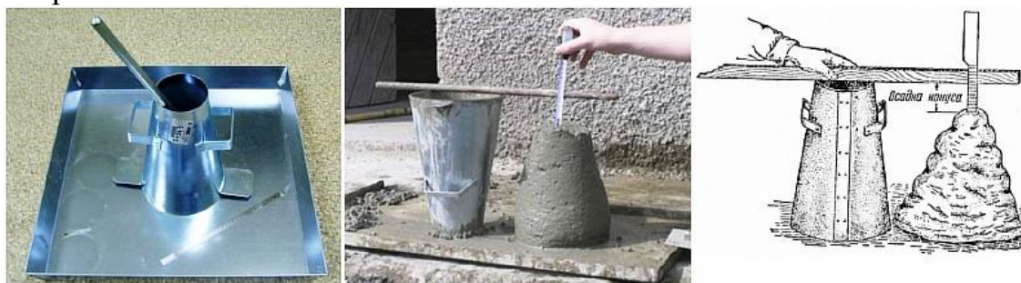
Рисунок 4.20 - Определение подвижности бетонной смеси по осадке бетонного конуса
