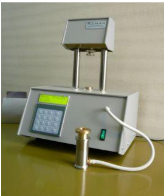
Рисунок 4.19 - Схема прибора ПСХ-10 для определения удельной поверхности вяжущих
