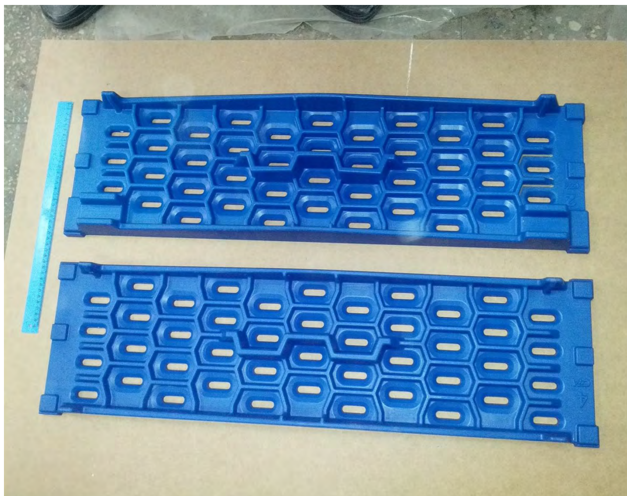
Рис. 3.3. Модельные комплекты с большими линейными размерами
