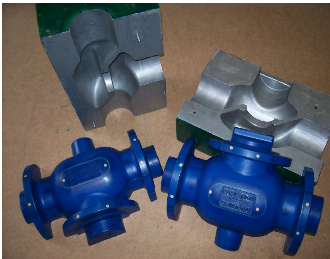
Рис. 3.1. Модели и стержневые ящики из пластполимеров
