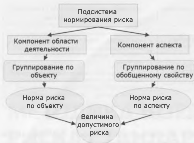
Рис. 2. Модель подсистемы нормирования риска стандартизации строительной отрасли
