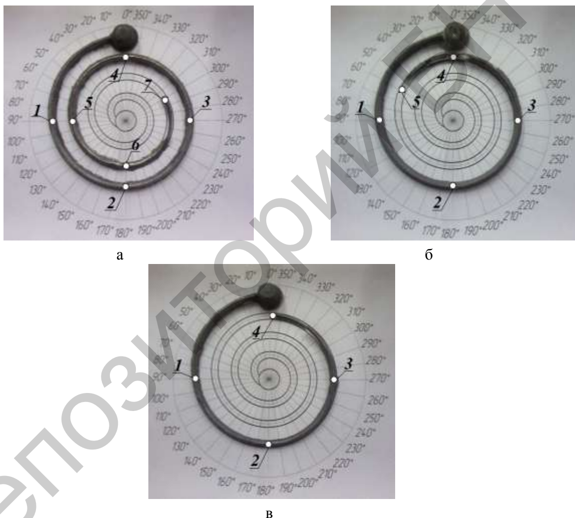
а – противопопригарное покрытие, модифицированное наноструктурированным бемитом; б – противопопригарное покрытие без модификатора; в – неокрашенная форма 1–7 – контрольные точки на спирали Керри;
