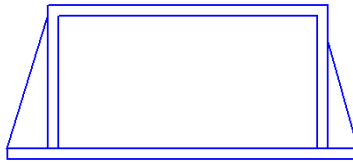
Рис.1.35. Примеры использования ребер жесткости
