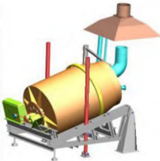
Рис.1 - Ротационная качающаяся плавильная печь
