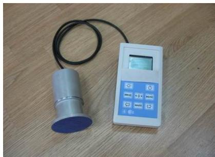
Рис. 1. Внешний вид макета портативного микроволнового влагомера
