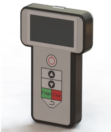
Рис. 1. Твердотельная модель блока управления тренажёром
