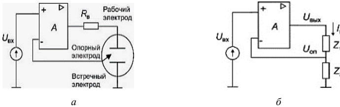
Рис. 1 Потенциостат и сенсор: основная схема – а, эквивалентная схема – б
