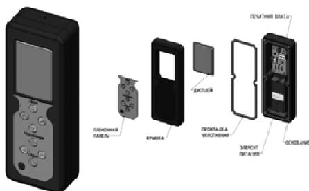
Рис. 1. Твердотельная модель термоанемометра
