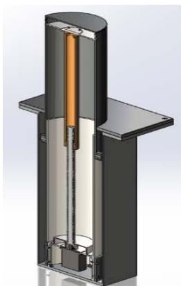
Рис. 1. Внешний вид разработанного болларда
