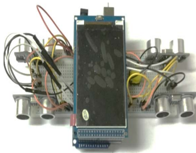
Рис. 1. Прототип устройства сигнализации парктроника
