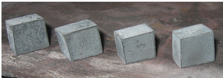
Рисунок 1 – Опытные образцы после оксидирования (20ХН4ФА, 20ХН4ФА, 6ХВ2С, 6ХВ2С)
