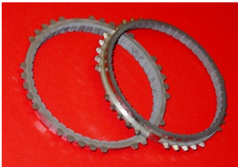
Рисунок 1 – Порошковые заготовки детали «Кольцо блокировочное» синхронизатора коробки передач трактора «Беларус»
