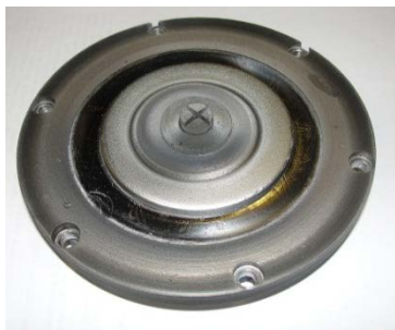
Рисунок 1 – Внешний вид комбинированного катода (Mo+Si) (а), схема распыляемой поверхности при длительном распылении (б) и, удаляемый ионом Ar^+ кластер (в) и морфология поверхности Si конденсата (г)
