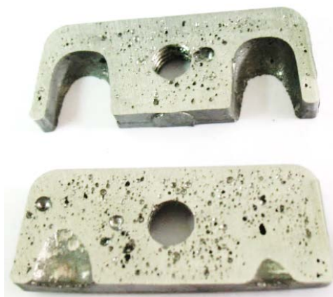
Рисунок 1 – Скопление газовой пористости в отливке «Крестовина»
