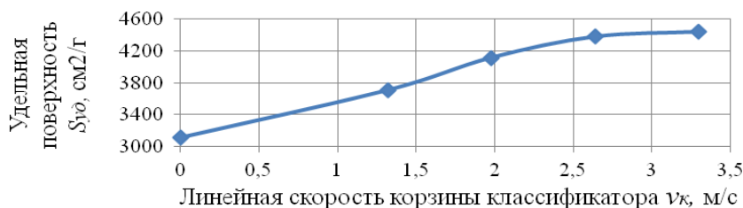
Рисунок 1 – Эффективность измельчения клинкера
