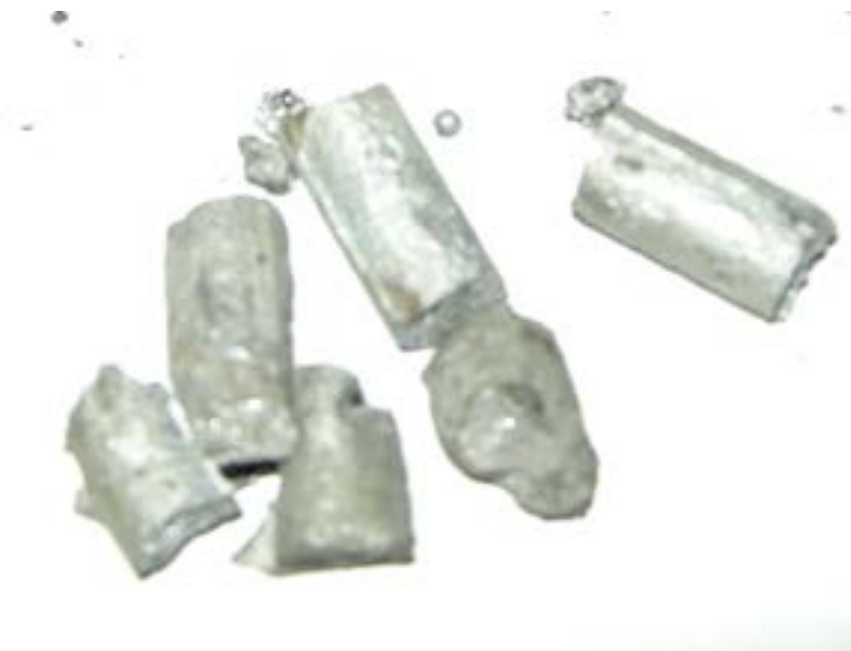
Рисунок 4 – Общий вид образца быстроохлажденного модификатора
