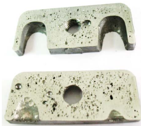
Рисунок 1 – Скопление газовой пористости в отливке «Крестовина»
