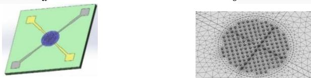
Рис. 1. 3D модель газового сенсора (а) и сетка конечных элементов на чувствительном слое (б)
