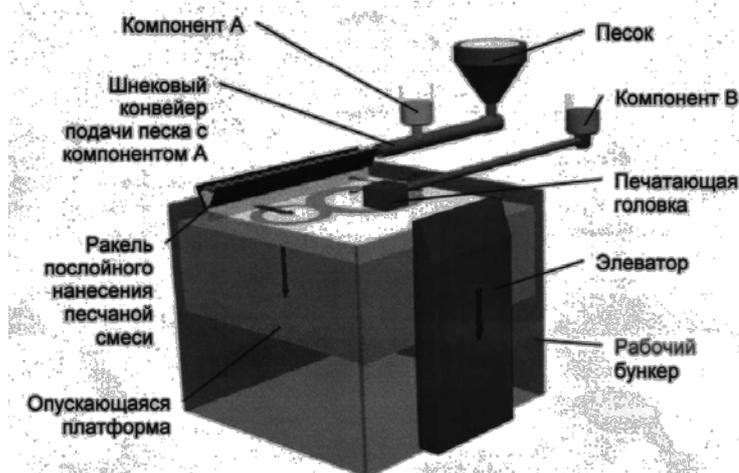
Преимущества данной технологии заключается в том, что она позволяет не только быстро изготавливать опытные образцы стержней и форм, но и отрабатывать технологию литья деталей для серийного производства. Кроме того, технология последовательного изготовления песчаных литейных форм и стержней на трехмерных принтерах позволяет изготавливать запасные части очень гибким и эффективным методом, так как САД чертежи могут быть воспроизведены с помощью оптической оцифровки уже изготовленных ранее деталей.
